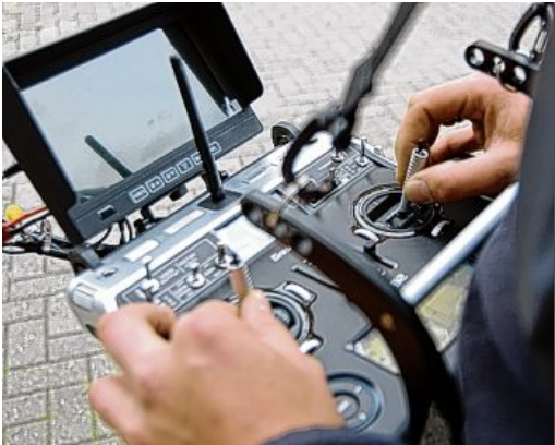
Der Pilot kann auf einem Bildschirm an der Fernbedienung das Livebild sehen.
