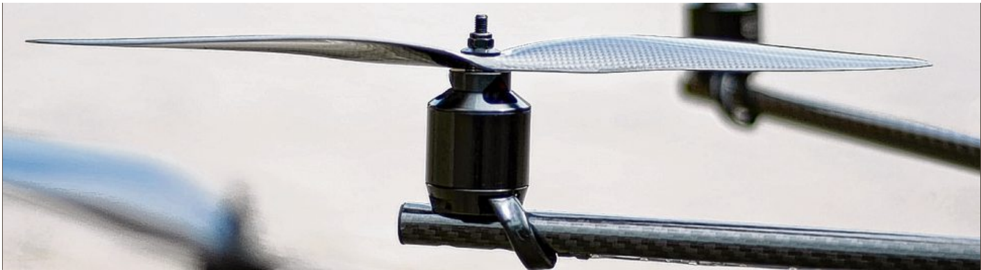
Die Propeller sind aus widerstandsfähigem Carbon gefertigt.
