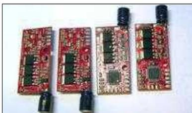
Im Gegensatz zu herkömmlichen BL-Reglern verfügt sie über einen schnellen Datenbus zur FC (I2C) und setzt die Motorsollwerte spontan um. Herkömmliche BL-Regler können nicht verwendet werden.
