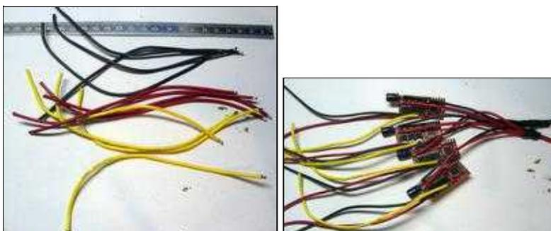
Den Komplettssets liegen 2 Farben Kabel (rot & schwarz) bei. Zum vorderen Ausleger/Motor sind 3 rote Kabel, für die anderen Motoren schwarze Kabel vorgesehen. Diese Farbkombination sieht optisch besser aus, wenn man die Leitungen nicht in den Auslegern verlegen möchte.
