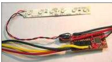
Die Leuchtbänder werden mit 12V versorgt. Am einfachsten ist es, wenn man sie mit einer dünnen Leitung an die Versorgung des vorderen Reglers (Nummer 1) anschließt. Hier reichen 4-5cm Leitungslänge. Das LED-Band vom Basisset mit den 6 LEDs kann man bei Bedarf in der Mitte auseinanderschneiden und unabhängig voneinander mit 12 Volt versorgen.
