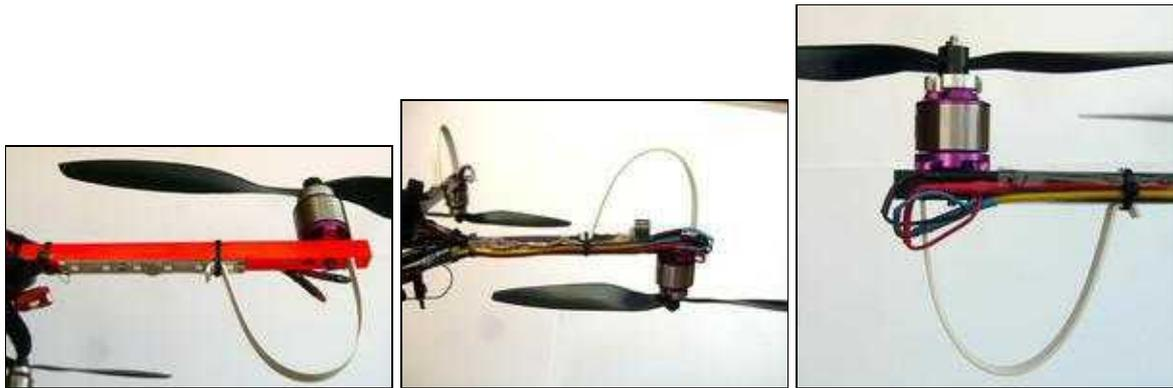
Die Motorleitungen der Motoren können außen oder durch die Ausleger verlegt werden. Bei dem Heckausleger kann man gleichzeitig die Leitungen für den Summerverlegen und den Summer dann mit Schrumpfschlauch am Ausleger befestigen.
